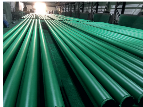
Stahlrohr in AD 168 mm mit Korrosionsschutzklasse C5 M in RAL 6010
