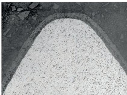
Metallografischer Schliff der KEPLA-COAT®-Schicht an einem Gewindekamm.
