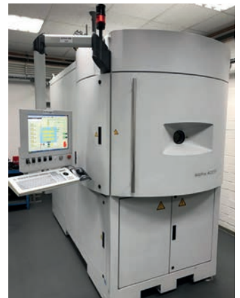
PVD-Anlage mit Duplex-Einheit (Nutzvolumen D 400 x 500 mm).
