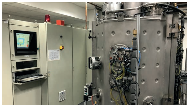
PVD-Anlage (Nutzvolumen D 600 x 900 mm).
