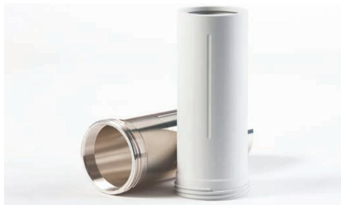
Magnesium-Bauteil: links ohne, rechts mit MAGOXID-COAT®-Beschichtung.
