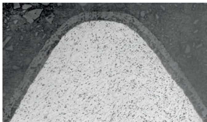
Die Schemazeichnung verdeutlicht den Oxidkeramik-Metall-Verbund beim MAGOXID-COAT®- bzw. KEPLA-COAT®-Verfahren.
