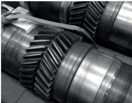
Mit Molybdän beschichtete Lagersitze einer Antriebswelle zur Vermeidung von adhäsivem und abrasivem Verschleiß.
