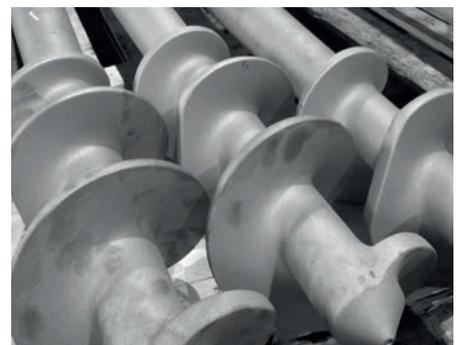
Verschleißschutz von Förderschnecken durch Flammsspritzen und Einschmelzen einer Nickelhartlegierung.
