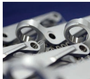
IVD-Aluminium-beschichtete Bauteile mit Maskierung im inneren Durchmesser. Nach der Beschichtung erfuhren die Bauteile eine Chrom(III)-haltige Passivierung.
