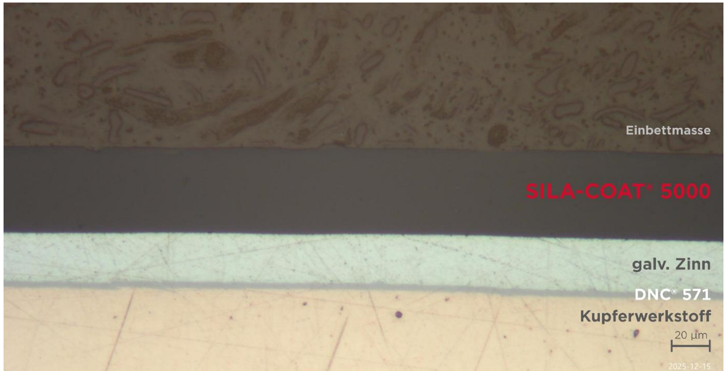
Abbildung 3: Kupferwerkstoff mit Schichtkombination DNC® 571 + galv. Zinn + SILA-COAT® 5000
